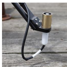
Kit PAR, montage sur ligne de mouillage, intégration sur bouée de surveillance
