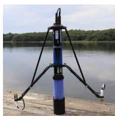
Kit PAR, montage sur ligne de mouillage, intégration sur bouée de surveillance
