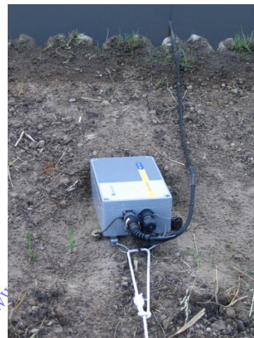
Station temporaire sur berge d'un canal (sonde de niveau)
