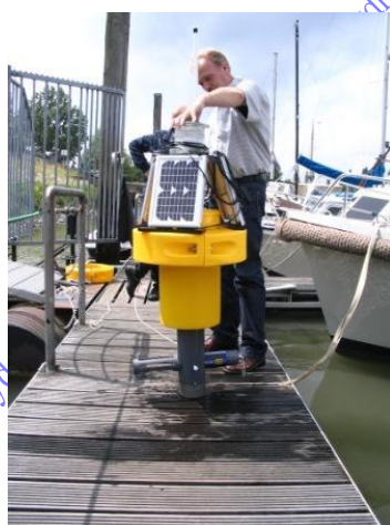
Ensemble pour bouée d'opportunité avec conteneur batterie permutable
