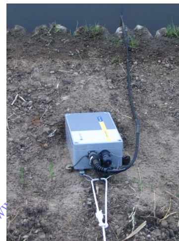
Station temporaire QBox sur berge d'un canal (sonde de niveau)
