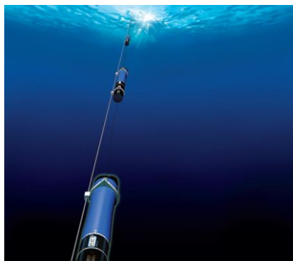
Mesure ponctuelle, montage sur ligne de mouillage, intégration sur bouée de surveillance
