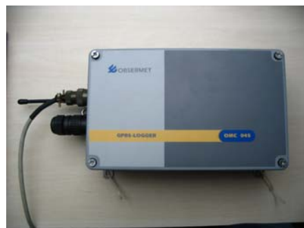
OMC-045 en boîtier IP68 avec connexion pour sonde YSI
