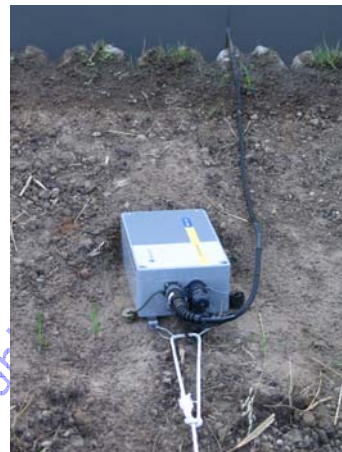
Station temporaire en bord d'un canal (enregistrement de niveau)
