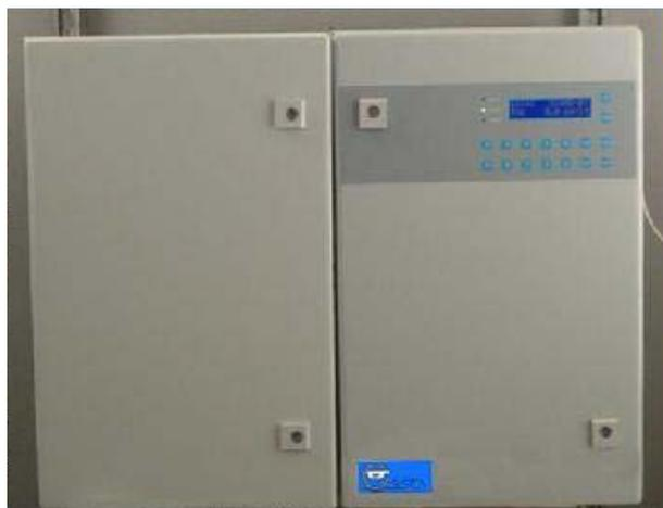
**MICROMAC TOC NDIR** est un analyseur en ligne piloté par microprocesseur, spécialement conçu pour la surveillance automatique du COT dans différents types de matrices aqueuses.
