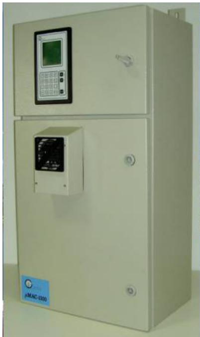
**MICROMAC AMMONIA** est un analyseur en ligne contrôlé par microprocesseur spécialement conçu pour la surveillance automatique de l'ammonia sur plusieurs types de matrices d'eau.
