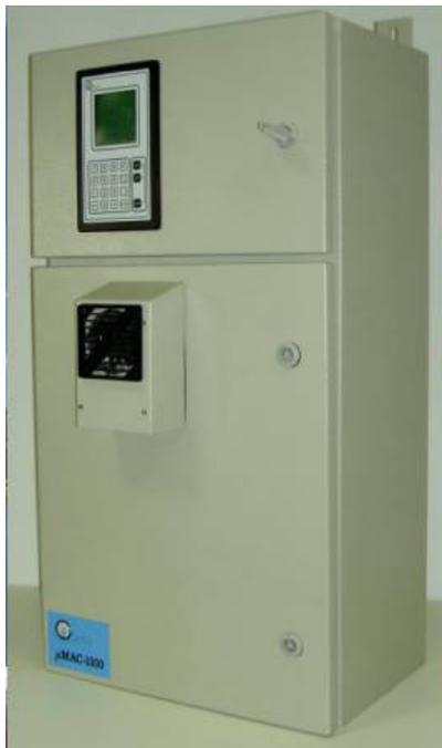
**MICROMAC HARDNESS** est un analyseur en ligne contrôlé par microprocesseur, spécialement conçu pour la surveillance automatique du TH – dureté sur plusieurs types de matrices d'eau.
