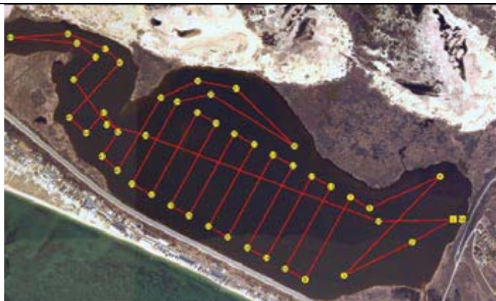
Ecran de planification de mission du logiciel VectroMap montrant la navigation d'une reconnaissance de style « moissonneuse » sur une image de lagon salé
