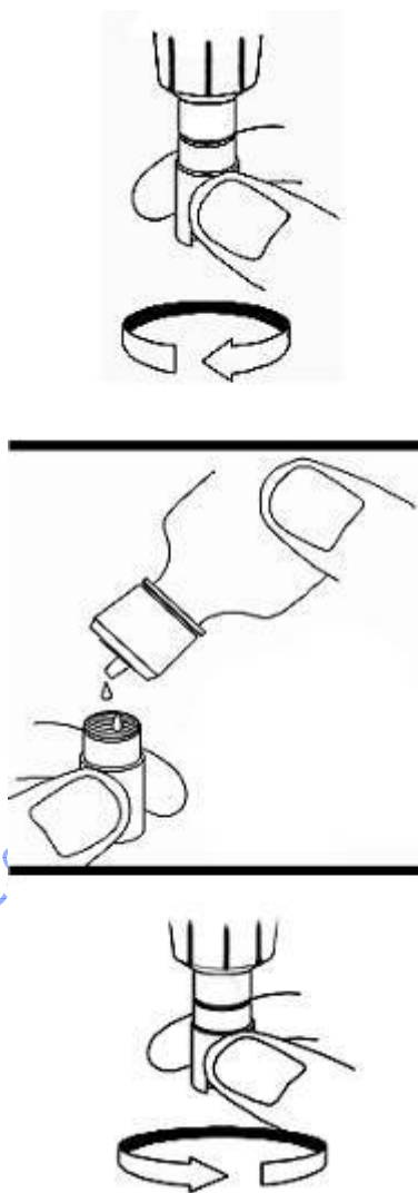
Figure 42 – Séquence de dessins montrant le remplacement d'une membrane capuchon.
