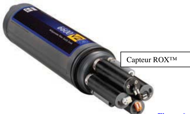
Figure 6 – Le racleur et les accessoires anti-fouling dédiés au capteur ROX™ aident à prolonger les durées de déploiement tout en protégeant l'intégrité des données ce qui le rend idéal pour les applications à distance de la surveillance non supervisée.
