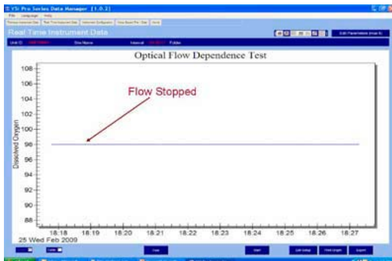
Figure 28 – Un graphe créé avec le logiciel YSI DataManager illustrant l'indépendance à l'écoulement d'un capteur optique.
