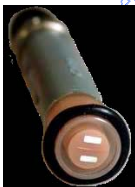
Figure 19 – Illustration des trois électrodes du capteur RapidPulse™
