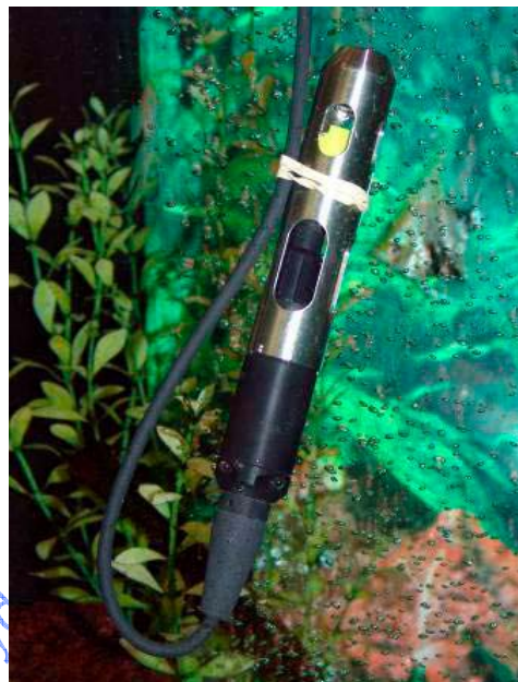
Figure 39 – Sonde O 2 d inversée afin d'éviter l'éclatement des bulles en surface de la membrane
