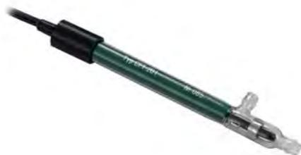
**CD-210** Cellule de conductivité avec électrodes platine, immergeable. Constante K=1cm<sup>-1</sup>, utilisée pour les liquides avec une forte conductivité de 1mS/cm à 800mS/cm.
