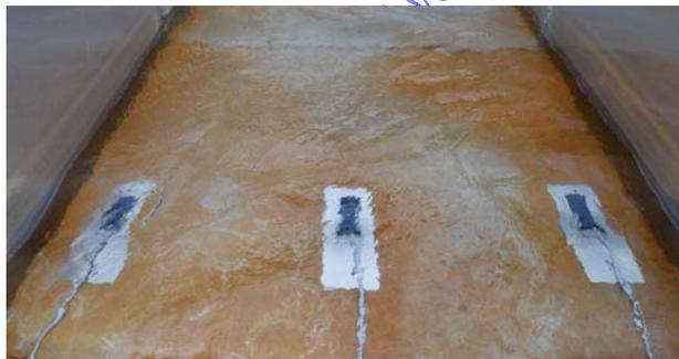
Les canaux supérieurs à 2 mètres de largeur ou diamètre peuvent présenter des variations significatives de vitesse sur la section transversale. En montant trois sondes de vitesse on mesure une moyenne du profil.
