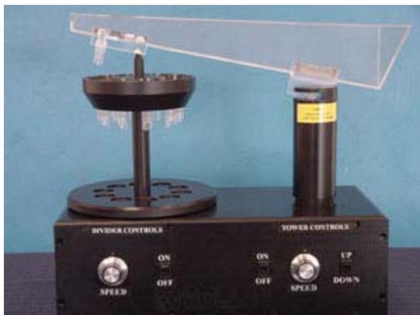
Le diviseur d'échantillon humide [McLane Parflux WSD-10](#) est conçu pour diviser un échantillon humide de particules en cinq ou dix parts égales, sans devoir auparavant sécher l'échantillon. Avec une destruction et une contamination minimales de l'échantillon du piège, le WSD-10 est particulièrement adapté à la préparation de haute précision des analyses biochimiques. Le diviseur est couvert d'une garantie de 36 mois.
