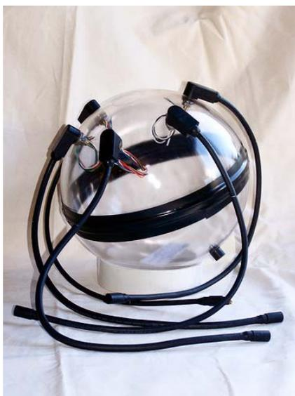
Sphère avec connexions passe cloison
