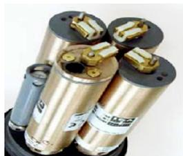
Capteurs optiques sur sonde
