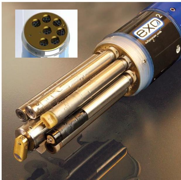
La sonde ExO-2 est un instrument enregistreur autonome qui opère en totale autonomie sur ses piles dans l'idée de permettre des surveillances discrètes.
