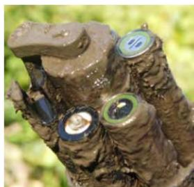
La sonde ExO-3 est un instrument enregistreur autonome qui opère en totale autonomie sur ses piles dans l'idée de permettre des surveillances discrètes.
