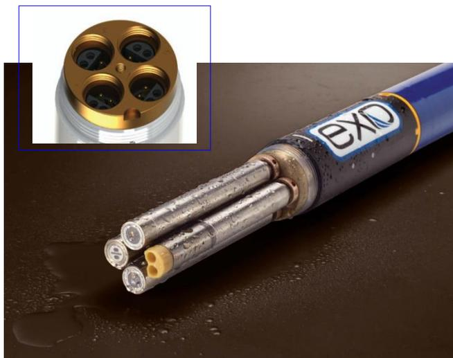
La sonde YSI ExO-1 est un instrument enregistreur autonome compact qui opère en totale autonomie sur ses piles dans l'idée de permettre des surveillances discrètes.
