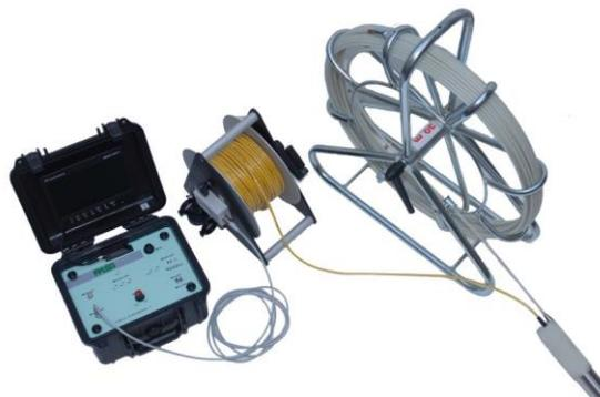
**ASPO-50** : 50 mètres de câble fibre de verre et adaptateur Téflon pour tête de caméra. Dimensions 510mm x 620mm x 220mm – poids 5,55kg. Adaptateur diamètre 42mm x 120mm
