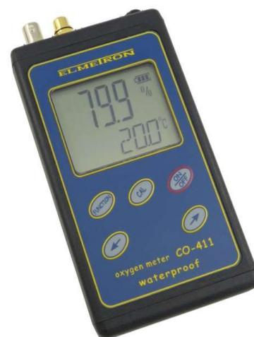
Le jeu standard inclut la sonde d'oxygène **COG-1** et le capteur de température **CT2B-121** avec résistance **Pt-1000B**.
