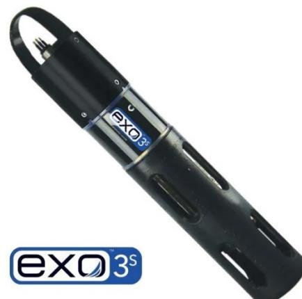
Les sondes YSI ExO-x<sup>S</sup> reprennent les bases bien connues de leurs cousines YSI ExO-x dans l'idée de se centrer sur les applications nécessitant plus de compacité et devant se contenter d'une alimentation externe via le câble submersible: surveillance par bouée ou station de surface, découverte et arpentage par robots, AUV et drones, collecte & transmission de données.
