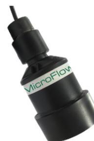
**MicroFlow** est un capteur sans contact de la vitesse d'écoulement liquide, qui utilise la technologie micro-ondes pour transmettre de courtes impulsions qui vont se refléter sur une surface mobile et revenir vers le capteur. Elles sont alors analysées pour déterminer la vitesse.
