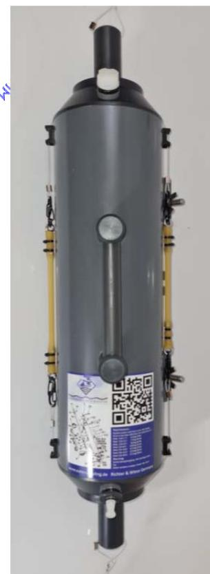
**Bouteille de prélèvement d'eau standards PVC conformité Niskin:**
