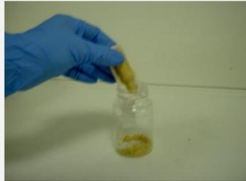
Fermer le flacon au Parafilm et avec le bouchon spécial percé, fourni en accessoire standard de l'analyseur en ligne, ensuite placer dans l'un des paniers d'échantillon du carousel de l'analyseur.
