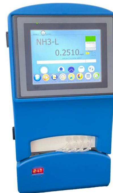
Analyseur piloté par microprocesseur, spécialement conçu pour l'analyse automatique sur plusieurs matrices d'eau.
