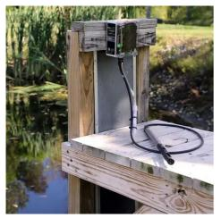
Changez de capteur avec l'enregistreur numérique YSI ProSwap Logger! Caractérisé par des capteurs intégrés de température et de profondeur, épaulés par une connexion banalisée pour l'un des capteurs numériques YSI DSS, l'enregistreur ProSwap Logger se transforme en ce dont vous avez besoin : un enregistreur de turbidimètre, d'oxygène dissous optique ou une CTD à prix abordable. Vous pouvez même surveiller les proliférations d'algues sur les baignades avec l'YSI ProSwap Logger!
