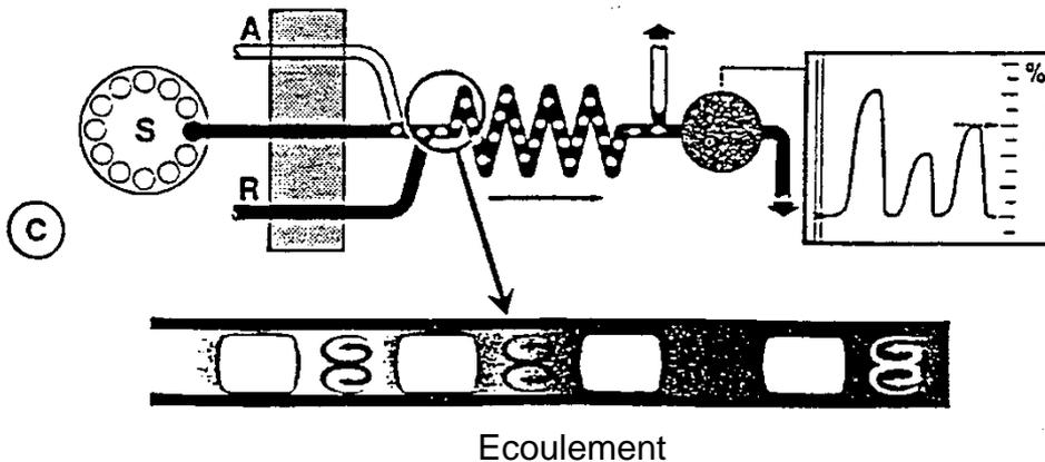
Mise en parallèle de la méthode manuelle et de l'analyse à flux continu FlowSys™
